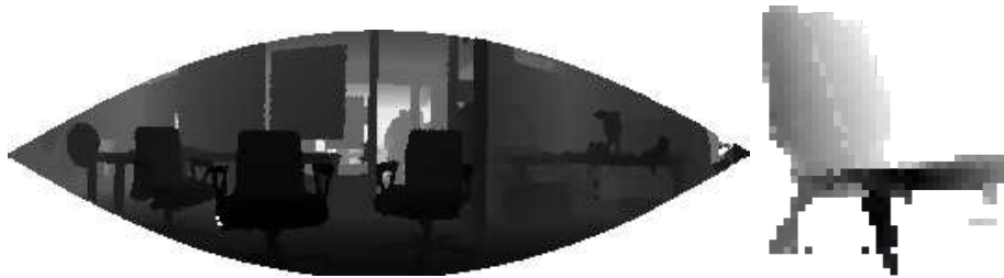
Abbildung 3.3: Beispiele für Tiefenbilder, das linke Bild zeigt das Tiefenbild für einen kompletten 3D Scan. Das Tiefenbild vermittelt einen guten räumlichen Eindruck der Szene. Das rechte Bild zeigt ein Tiefenbild für eine Objektteilansicht.
