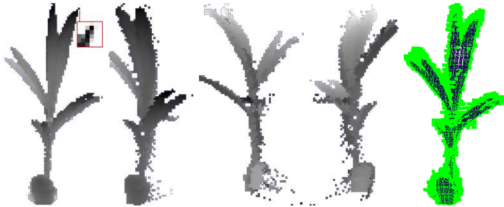
Abbildung 5.2: Auszüge einer Tiefenbilder Kollektion für ein initiales Modell. Das erste Tiefenbild zeigt die Ansicht von der Observationsposition. Für einen Punkt ist der 6 \times 6 Merkmaldeskriptor mit abgebildet. Die folgenden drei Tiefenbilder zeigen das selbe Modell aus verschiedenen Beobachtungspositionen und verdeutlichen, dass es sich bei dem Modell nur um eine Teilansicht handelt. Das fünfte Bild zeigt die Modellpunktwolke aus der Observationsposition und die, in der Tiefenbilderkollektion gefundenen, interessanten Punkte in grün.
