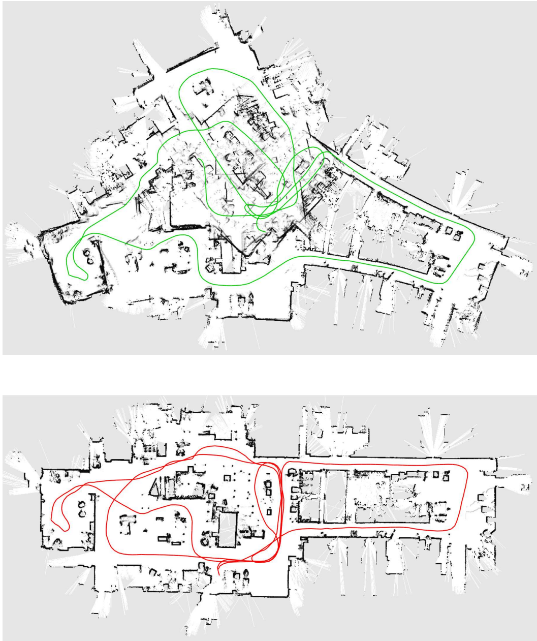
Abbildung 1.1.: Auswirkung der Odometriefehler. Die obere Abbildung zeigt eine Karte des Versuchfelds des Fraunhofer IPA (Stuttgart). Sie basiert auf den durch die Odometrie berechneten Roboterpositionen. Die untere Abbildung zeigt eine Karte der selben Umgebung, die anhand von korrigierten Odometriemessungen erstellt wurde. Der geschätzte Pfad des Roboters ist in grün bzw. rot zu sehen.
