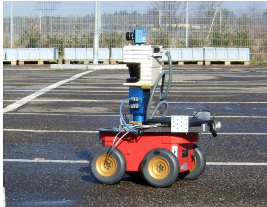
Abbildung 5.7.: ActivMedia Pioneer 2-AT Roboter mit einem SICK LMS Laserscanner.
