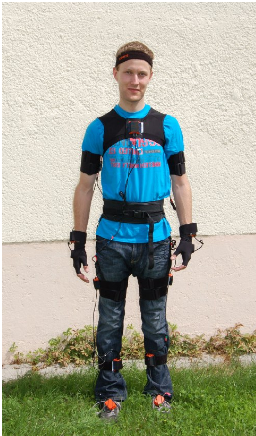
Abbildung 5.4: Links: Der XSens-Datenanzug. Rechts: Die 23 Körpersegmente, welche das MVN-Studio zurückliefert.
