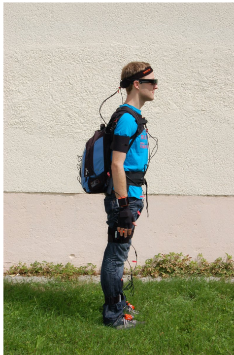
Abbildung 5.1: Eine Testperson im Bewegungsaufzeichnungsanzug mit Videobrille und mit zwei Notebooks im Rucksack.
