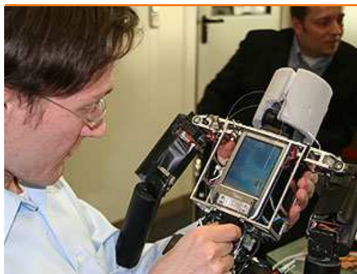
Was der Roboter mit dem Kameraauge sieht, verarbeitet ein Pocket-PC.
