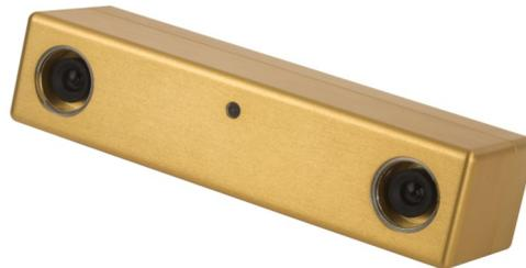
**Abbildung 2.5.:** Bumblebee2 Stereo-Kamera von Point-Grey
