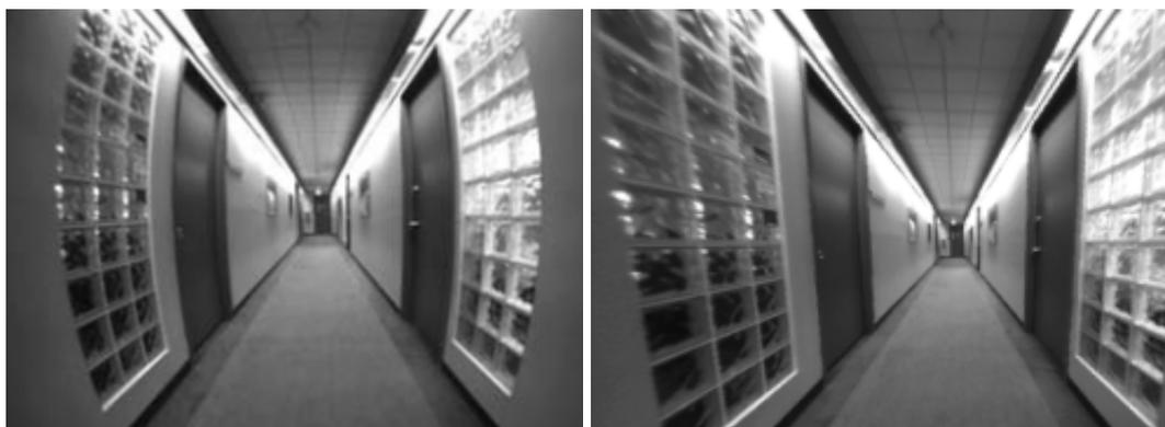
**Abbildung 2.6.:** Links: Rohbild mit tonnenförmiger Störung, die durch die Kameralinsen verursacht werden - Rechts: Rektifiziertes Bild mit geraden Kanten
