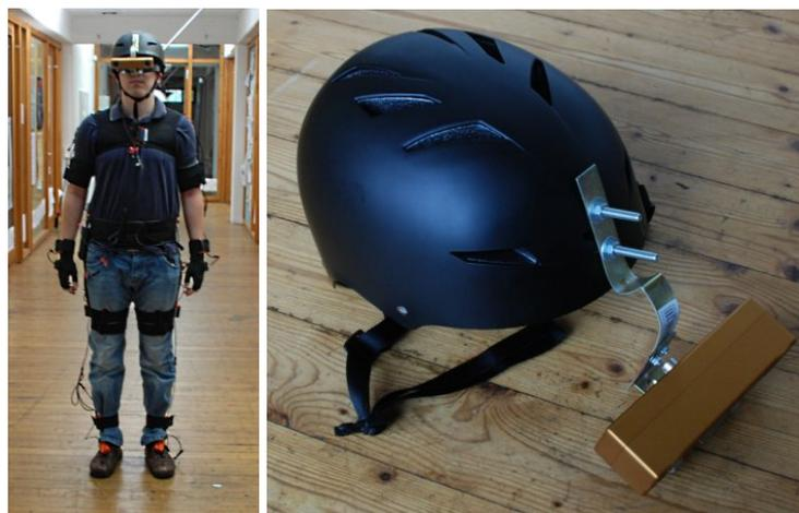
Abbildung 5.2.: Links: Der gesamte Anzug mit Brille und Kamera Rechts: Helm mit Kamera
