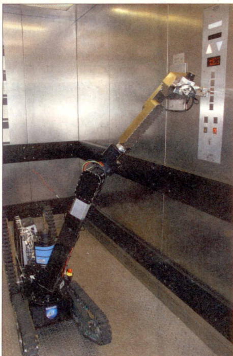
"In den vierten bitte" - Im Aufzug muss die Maschine den richtigen Knopf finden.
