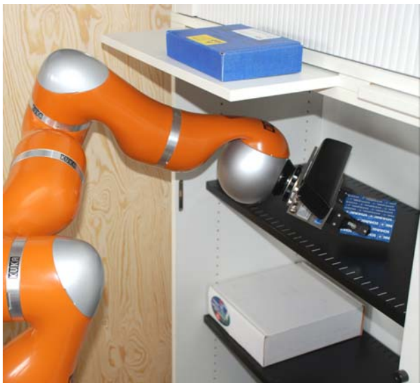
Bild 1 Nach dem Anfahren des Ziels ist ein großer Teil der Umgebung nicht mehr im Sichtbereich des auf dem Greifer platzierten Sensors. Zur weiteren Gewährleistung einer kollisionsfreien Trajektorie benötigt der Roboter daher eine dreidimensionale Belegungskarte des Arbeitsbereichs. Das im vorliegenden Beitrag beschriebene System erlaubt es eine solche Karte simultan zur Ansteuerung des Ziels zu erstellen.
