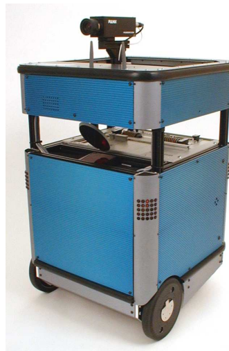
Figur 1: Pygmalion, der Roboter auf welchem die Experimente durchgeführt wurden. Es handelt sich um ein VME-basiertes System mit einer Robotersteuerung für 6 Achsen. Die Prozessorkarte trägt einen PowerPC bei 300 MHz. Neben Rad-Encodern und taktilen Sensoren, beherbergt das Vehikel einen Laserscanner und ein Videosystem (siehe Kapitel 2)
